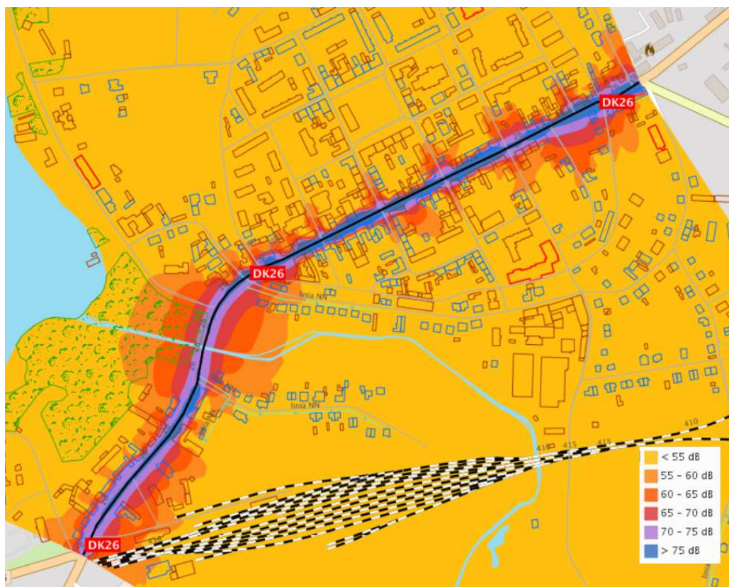
Ryc. 18. Mapa emisji hałasu dla L_{DWN} dla odcinka DK 26 w Myśliborzu Źródło: geoserwis.gdos.gov.pl (portal map akustycznych GDDKiA)
